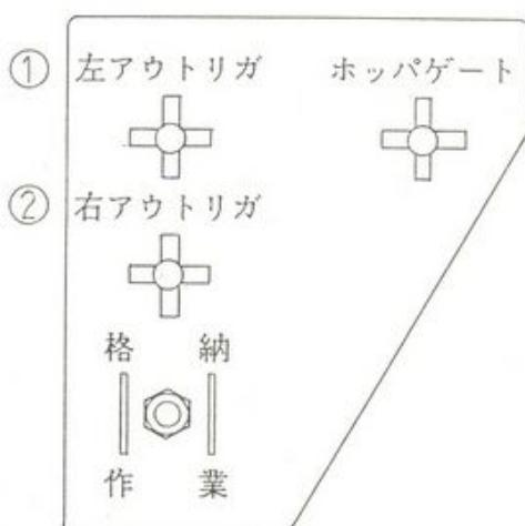
図-29 後アウトリガ操作盤
